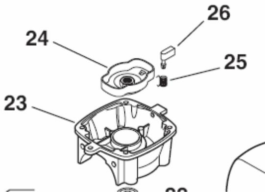
Diese Startsperr- Klinke gibt es in zwei Ausführungen. Bei einer Ausführung kann die Klinke, selbstrastend in die Bohrung eingeführt werden.
